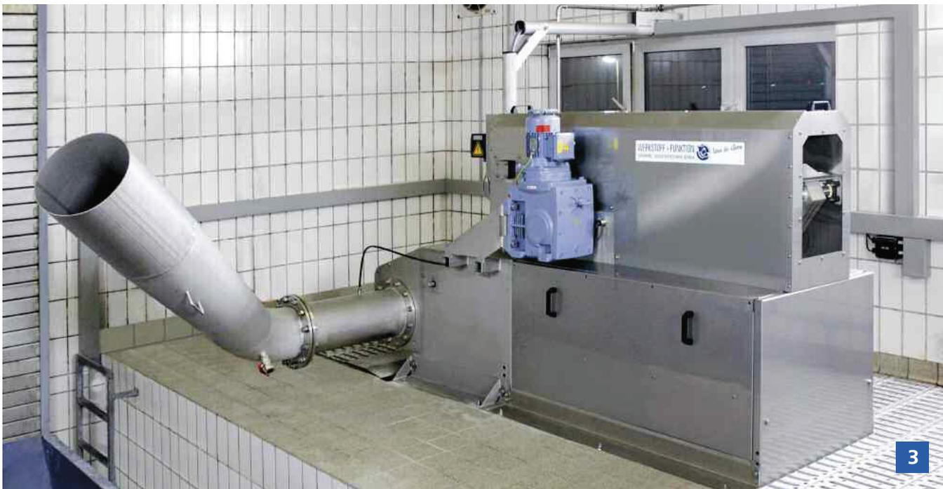
Pour les deux grands modèles de tamis FFR, à commande hydraulique, FFR 2,5 et 3.0, (photos 2 & 4) un pré-lavage des déchets durant leur remontée est possible. Ce dispositif réduit la quantité de boues minérales remontées dans le compacteur-laveur et augmente donc sensiblement la durée de vie de ce dernier équipement. Pour les modèles plus petits (FFR 80 à FFR 130), adaptés à des profondeurs de canal plus faibles (Photos 1 & 3), ce pré-lavage n'est pas nécessaire.
