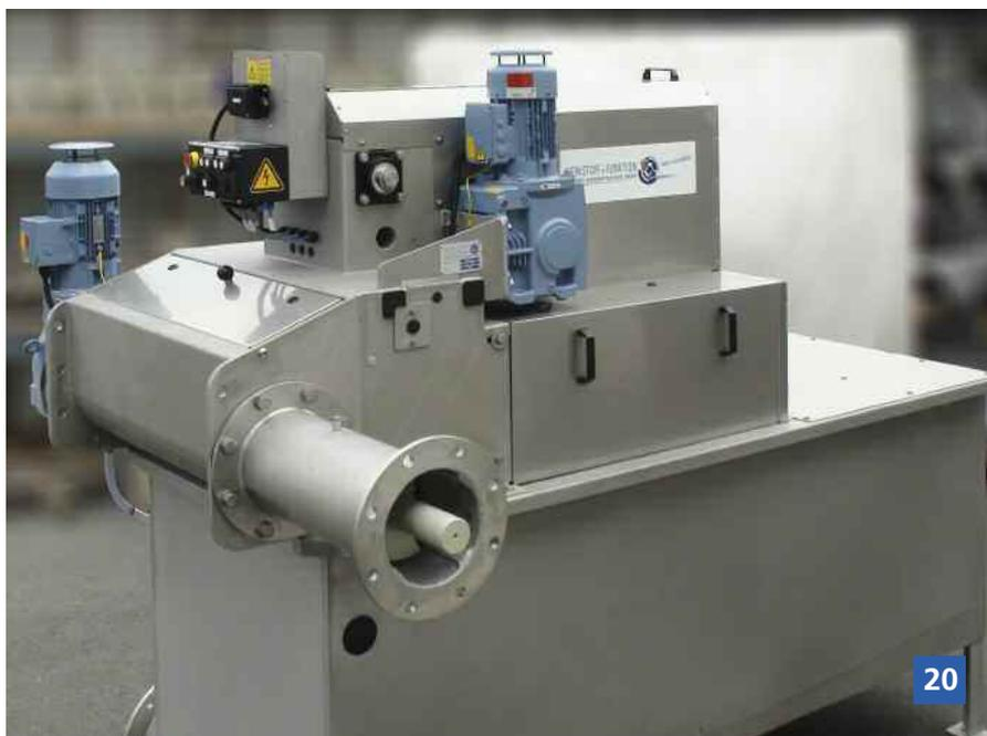
Les petits modèles de tamis plats FFR peuvent également être installés dans des cuves en acier inoxydable (photo 20), en solution variante à l'installation en canal béton. Le modèle FFR 80, le plus petit, est très souvent installé ainsi.
